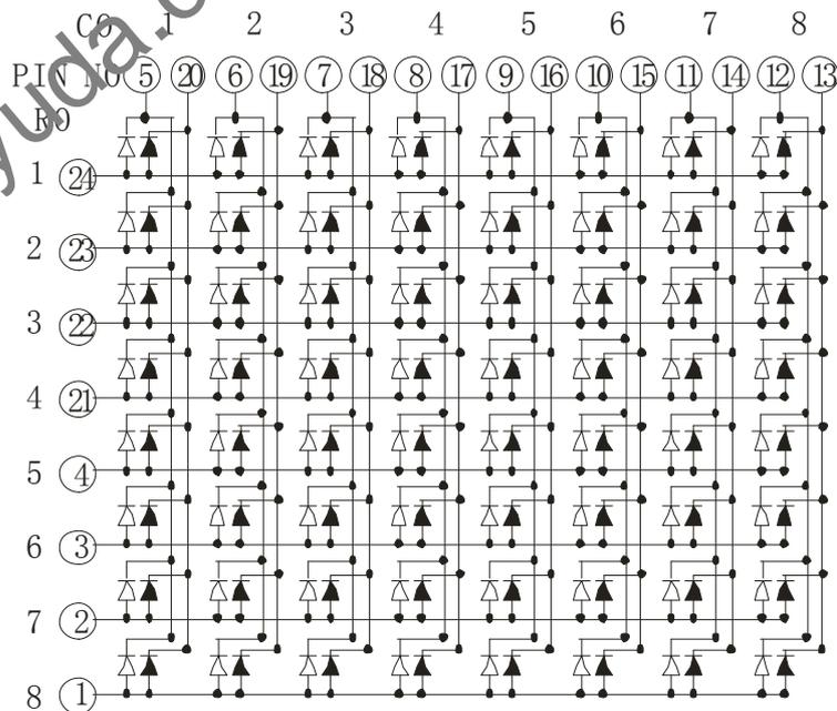
驱动电压为：正向电压×1 不同颜色的正向电压值不同,详见第二页光电参数表。
