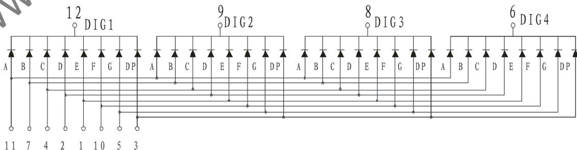
段驱动电压为： 正向电压×1
